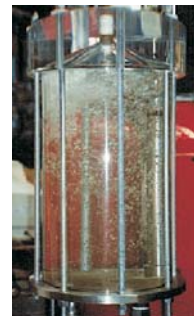
Bild 11: dynamische Vakuumentgasung am 'servitec'-Versuchsstand
