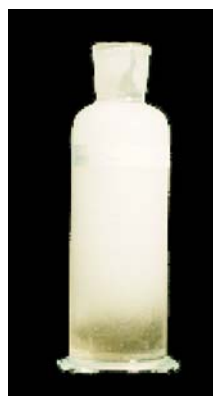
Bild 2: stickstoffübersättigtes, Heizungswasser nach der Probenahme
